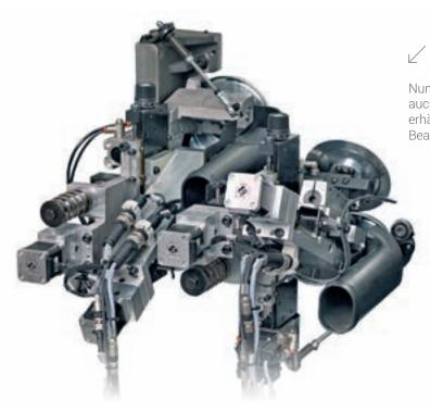
Numerisch gesteuerte Achsen sind auch beim Ziehklingenaggregat erhältlich, für maximale Bearbeitungspräzision.
