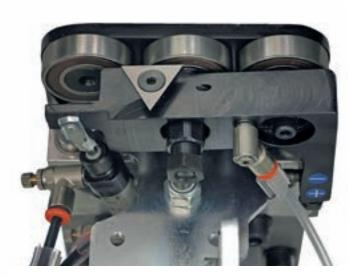
Das **Flachziehklingenaggregat**, das den Leim-überschuss am oberen und unteren Plattenteil entfernt, ist einzigartig am Markt. Es ist mit 4 Pneumatikzylindern für höchste Feinbearbeitungsqualität ausgestattet.
