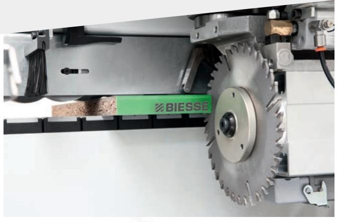
Zuverlässigkeit und Schnittpräzision dank des **Kappaggregats** zum Entfernen des Kantenüberstands am Plattenanfang und -ende. Das Kappaggregat sieht serienmäßig das Flex-System vor, das eine automatische Einstellung des Kantenüberstands gestattet.
