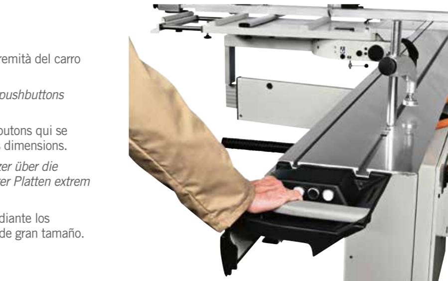
**Pulsanti sul carro.** La possibilità di avviare o spegnere i motori delle lame dai pulsanti posti all'estremità del carro risultando estremamente di aiuto nella lavorazione di pannelli di grandi dimensioni.
