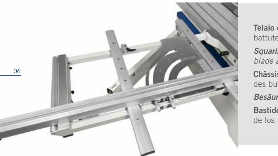
**Telaio di squadro con dispositivo "Compex"** dotato di compensazione automatica della posizione delle battute rispetto alla lama al variare dell'angolo di inclinazione della riga.
