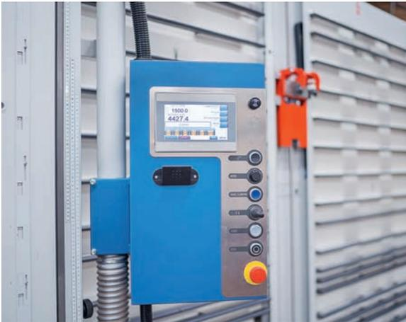
Das Bedienpult bei Elcon verfügt über Knöpfe sowie einen Touchscreen.
