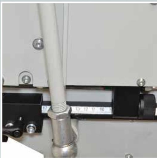
Réglage de la profondeur de perçage y compris réglage fin
