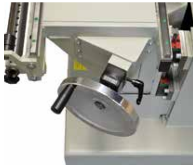
Réglage de la hauteur par affichage numérique avec une précision de 1 / 10 mm
