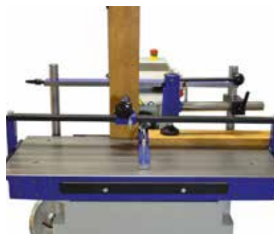
Portique de serrage pour serrage vertical des pièces à usiner
