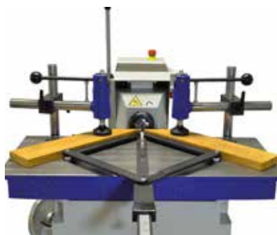
Agrégat de travail angulaire synchro pour angles de 22,5^\circ à 75^\circ
