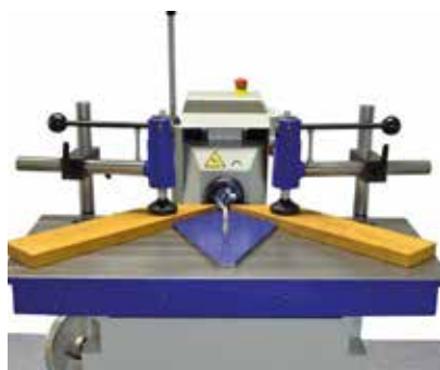
Agrégat de travail angulaire pour angle fixe de 22,5^\circ et 45^\circ
