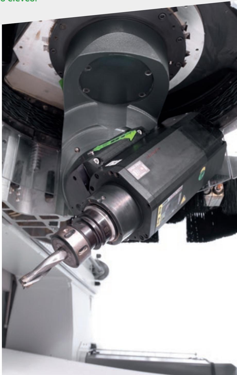
L'unité 5 axes de 16,5 kW et l'électrobroche de 19,2 kW, toutes deux avec 6 roulements céramiques de grandes dimensions, garantissent des enlèvements importants et une qualité de finissage maximale.
