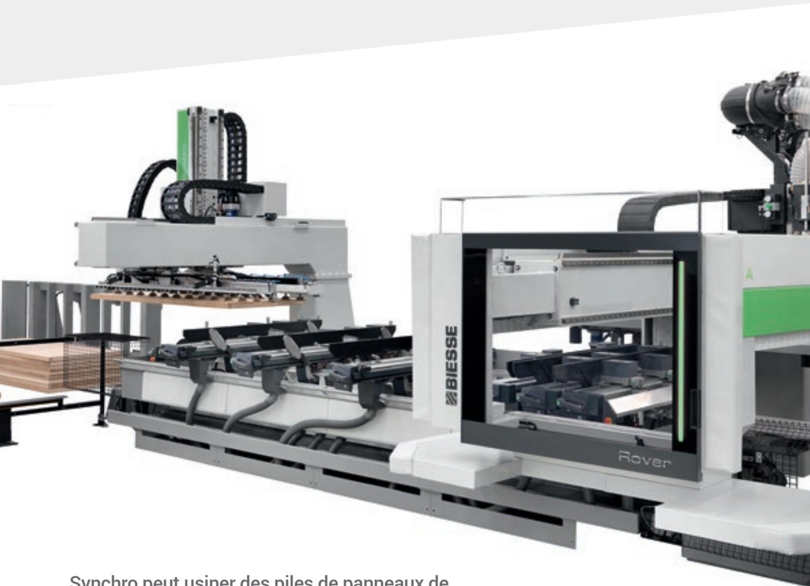
Synchro peut usiner des piles de panneaux de dimensions différentes les uns par rapport aux autres grâce au dispositif de référence de la pile et au cycle de pré-alignement du panneau, qui est exécuté en temps masqué tandis que le centre d'usinage Rover exécute le façonnage du panneau précédent.
