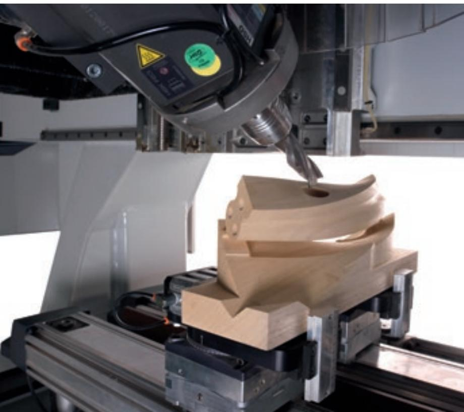
La rotation continue de l'axe B et C de l'unité de fraisage à 5 axes, possible grâce à des composants à la pointe de la technologie, garantit une vitesse de façonnage et une qualité du produit fini maximales.
