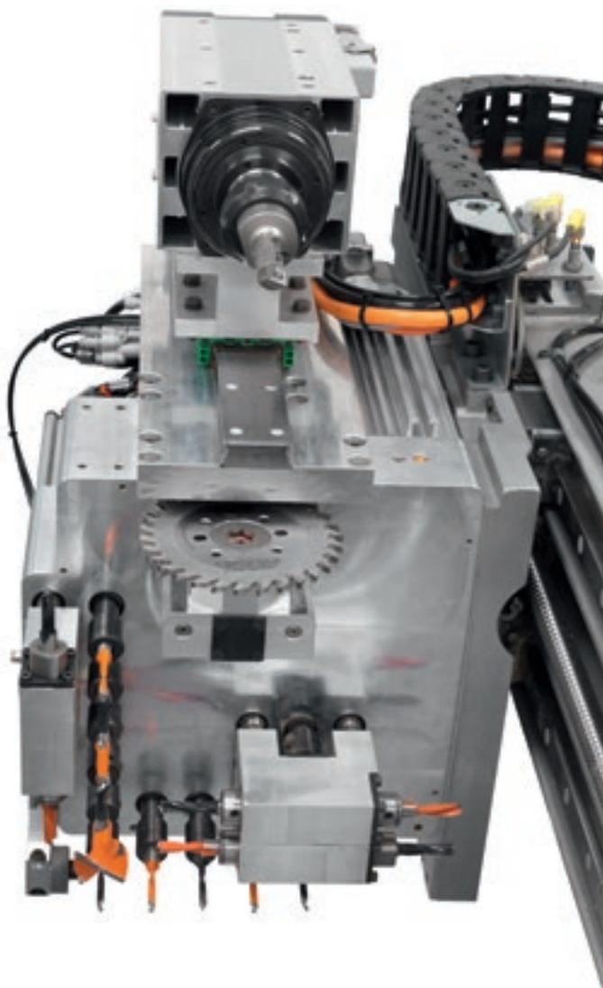
Es sind Fräseinheiten von 4,5 bis 5,5 kW und Bohreinheiten mit 17 oder 23 Werkzeugen erhältlich.
