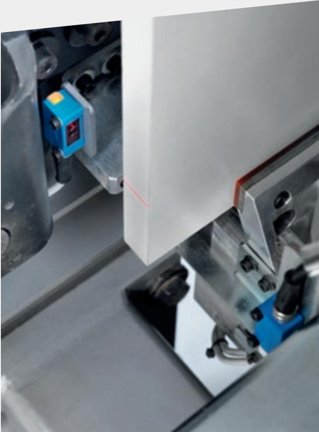
Dank dem laserbasierten **Lesesystem** zum Erkennen des Nullpunkts und des Plattenendes kann die Maschine die Längentoleranzen durch Korrigieren der Plattenmaße in X kompensieren.
