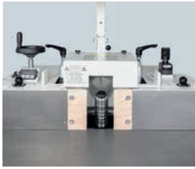
Butée de fraisage type 2620 avec mors de butée en fonte, AIR-LOCK
