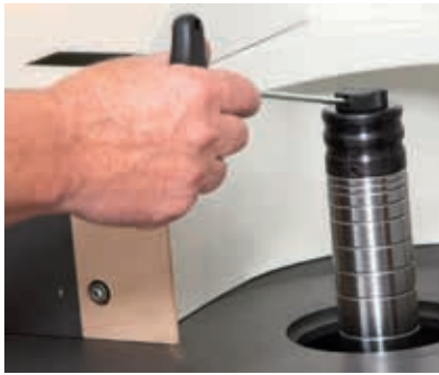
arbre de fraisage avec écrou à serrage rapide „fix
