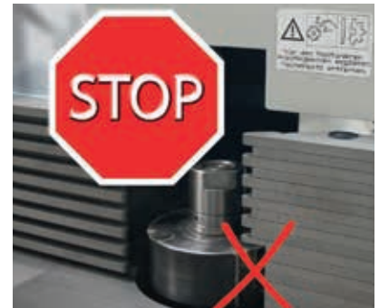
Gardien (le serrage des mors de butée est contrôlé)
