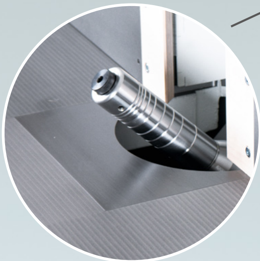
Tisch mit Tischieber zur schnellen und optimalen Anpassung der Tischöffnung an das Werkzeug
