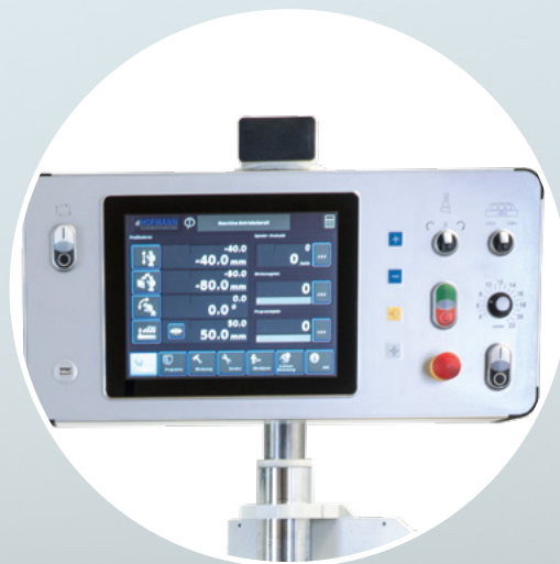
Großzügiges, modernes Bedienpult mit 12,1" Touch Monitor
