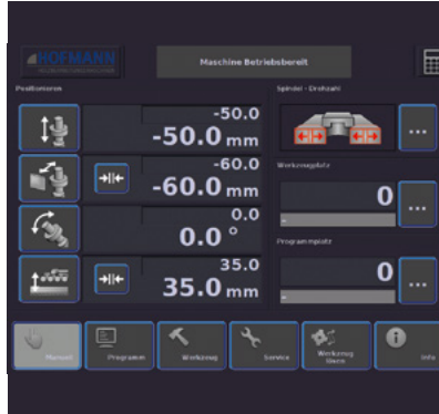
Guardian Überwachung der Anschlagbacken- klemmung in der CNC-Steuerung
