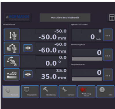
Werkzeugwechsel Lösen der HSK-Schnittstelle über das Touch-Bedienfeld
