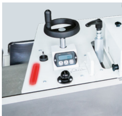
Sicherheitslichtleiste am Fräsanschlag
