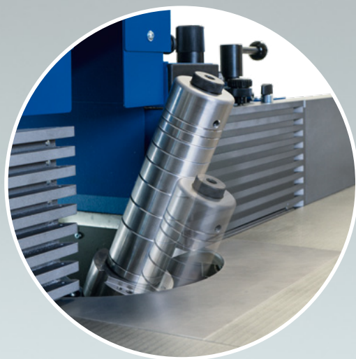
Höhenverstellung erfolgt linear über die Spindel
