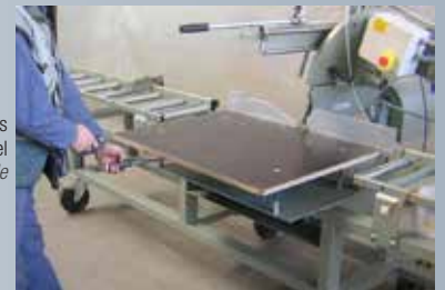
Maschine von vorne neigbar, mittels einhängbarer Handkurbel Machine inclinable à moyen d'un manivelle
