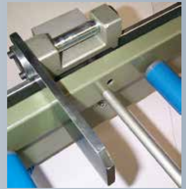
Materialschieber nach hinten wegschwenkbar Butée escamotable sur l'arrière
