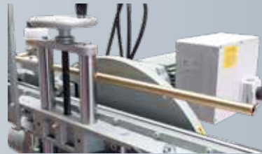
Hydraulische Vorschubbremse (Umkehrbremse) Frein anti retour
