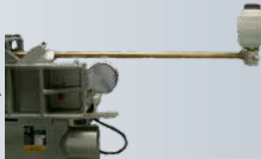
Hydraulische Vorschubbremse Frein hydraulique pour l'avan- cement
