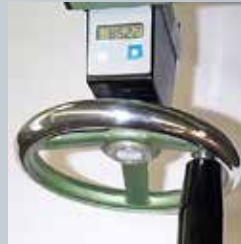
Handrad mit Digitaler Anzeige Volant de déplacement du guide avec mesure à affichage digital
