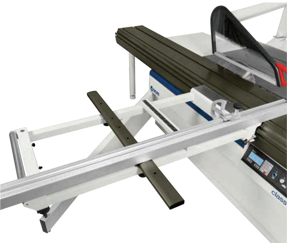
**Traitement de renforcement de surface pour le chariot coulissant et les traverses mobiles du châssis à équarrir**
