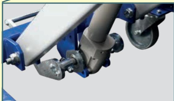
Dispositif à vérin hydraulique de construction massive sur bâti mécano – soudé
