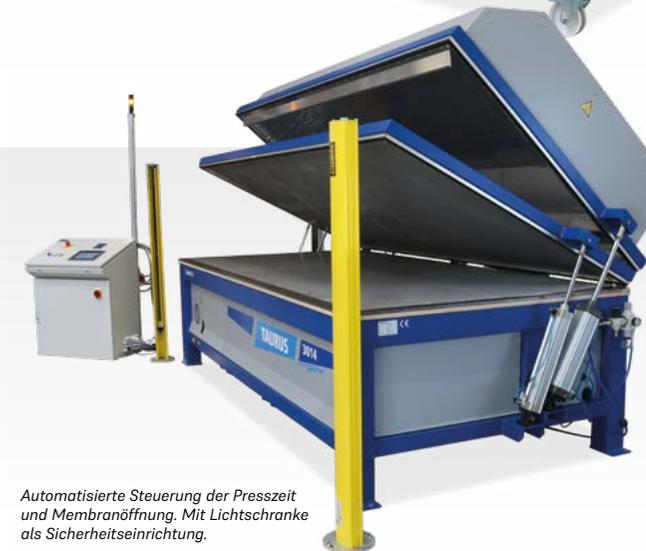
*Automatisierte Steuerung der Presszeit und Membranöffnung. Mit Lichtschranke als Sicherheitseinrichtung.*
