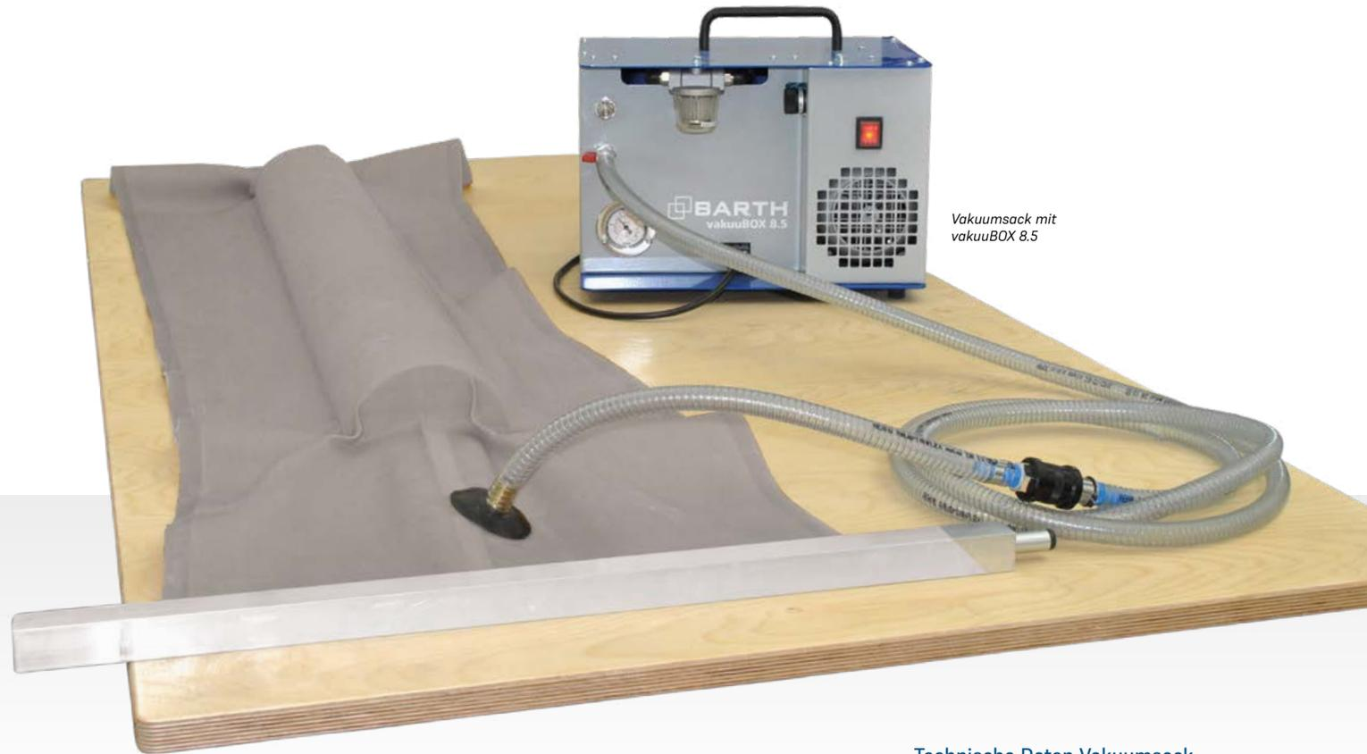
Vakuumsack mit vakuuBOX 8.5
