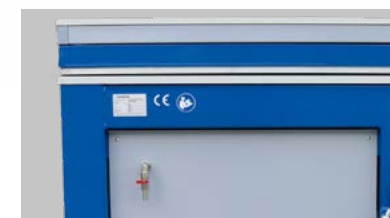
Branchement pour vide Branchement supplémentaire pour sac sous vide
