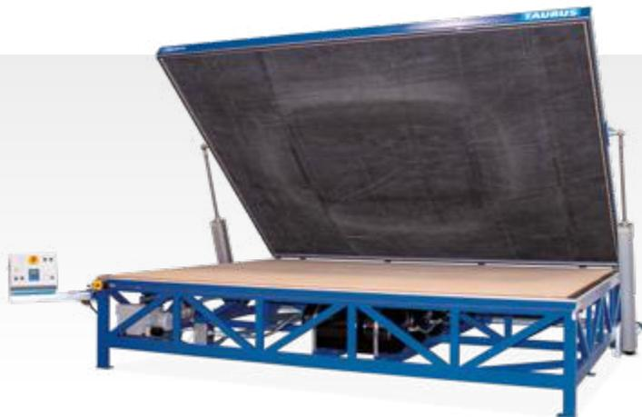
Automatisierte Steuerung der Presszeit und Membranöffnung. Mit Lichtschranke als Sicherheitseinrichtung.
