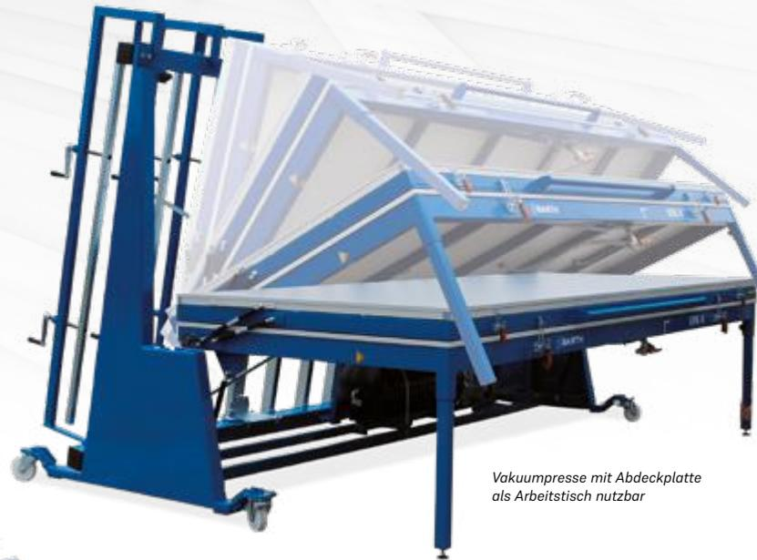
Vakuumpresse mit Abdeckplatte als Arbeitstisch nutzbar
