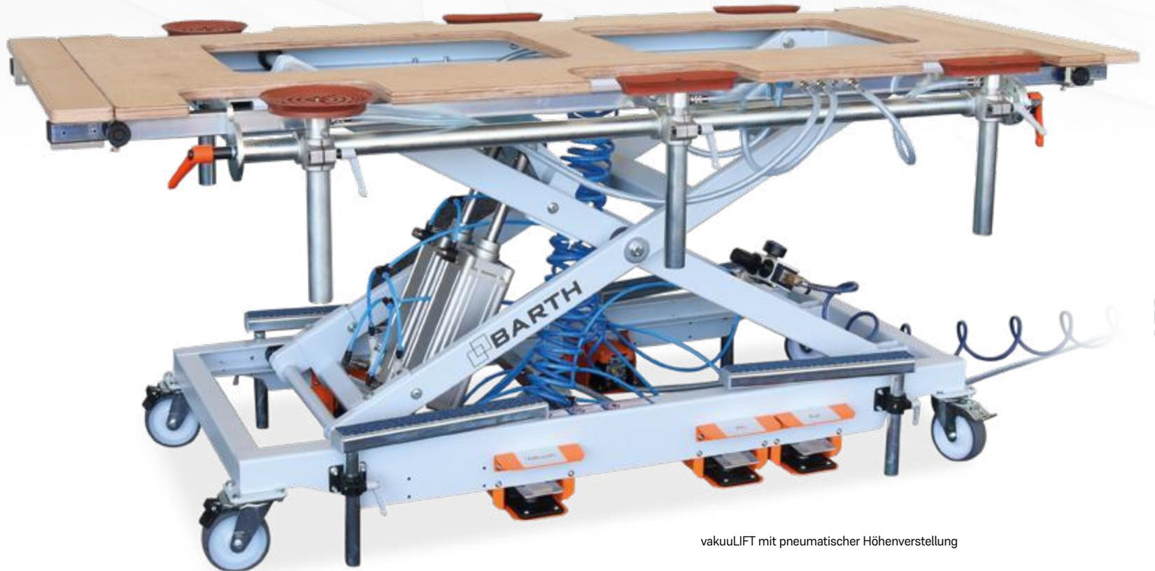
vakuuLIFT mit pneumatischer Höhenverstellung
