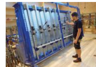
Presse à vide avec plaque de recouvrement utilisable comme table de travail
