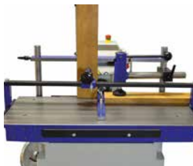
Spannbrücke zum senkrechten Spannen von Werkstücken
