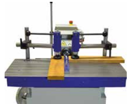
Rahmendübelanschlag 3-fach umsteckbar
