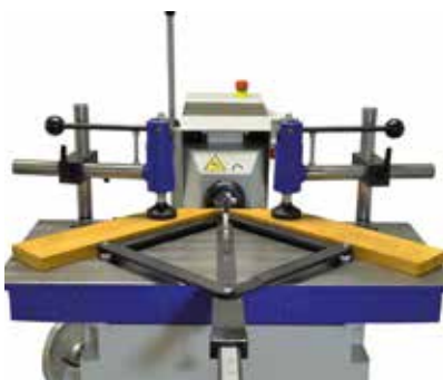
Doppelwinkelverstellanschlag für Winkel von 22,5° bis 75°
