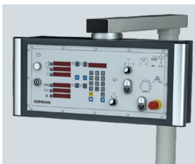
Bedienpult bei Ausführung Standard/Automatik
