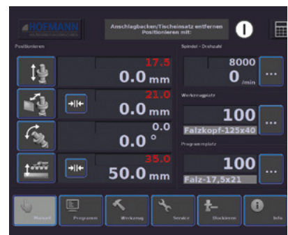
Beispiel Maske bei CNC-Steuerung
