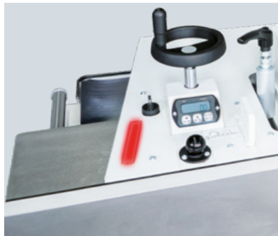
Sicherheitslichtleiste am Fräsanschlag
