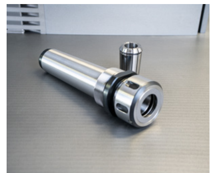
Spannzangenfutter mit Spannzange
