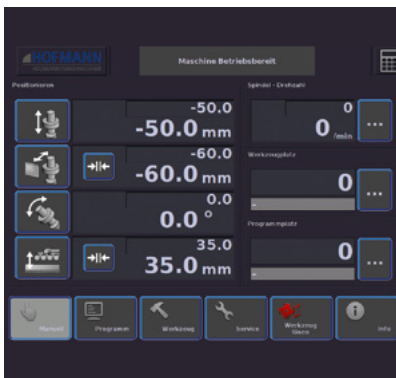
Werkzeugwechsel Lösen der HSK-Schnittstelle über das Touch-Bedienfeld
