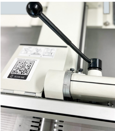
Anschlagverstellung über Einhandbedienung nach Gradanzeige
