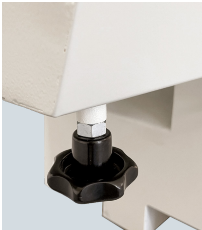
Komfortable Einstellung des Abstandmetisches zur Messerwelle
