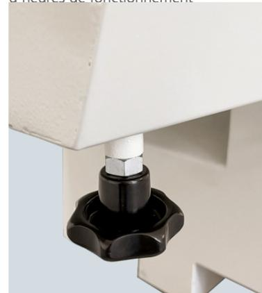
Réglage confortable de la table d'enlèvement par rapport à l'arbre porte-couteaux
