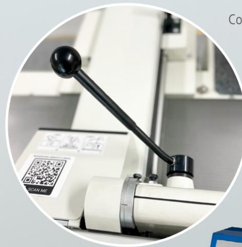
Commande à une main pour le réglage du guide
