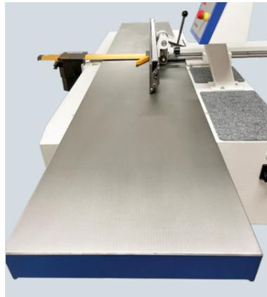
Tables en fonte de 3 000 mm, chacune mesurant 1 500 mm, avec profil longitudinal
