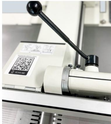
Réglage du guide par commande à une main avec affichage d'angle
