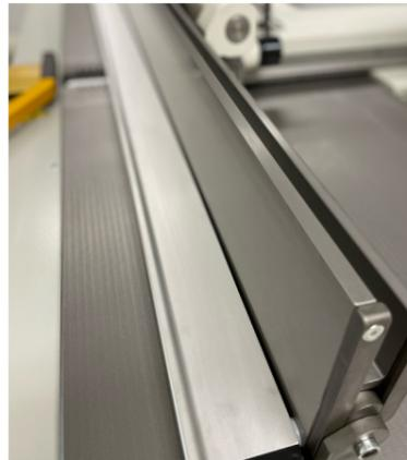
Butée auxiliaire intégrée dans le guide principal pour les pièces minces
