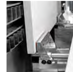
Automatisches Vermessen der Dicke der Teile Mesure automatique de l'épaisseur des pièces
