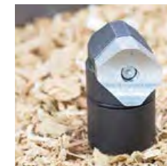
Geschraubter Messhalter/ Porte- couteaux avec vis de fixation
