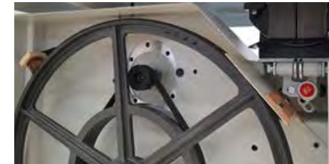
Speichen-Gussräder standard ab Modell BS640/ Volant en fonte à rayons standard à partir du modèle BS640
