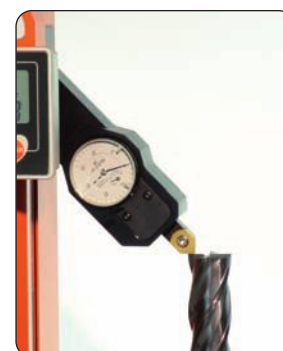
Misurazione dell'altezza How to measure tool length
