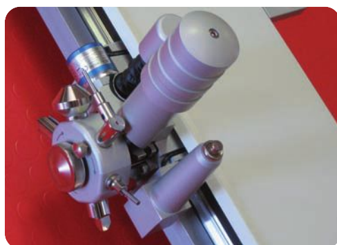
Revolver a 6 posizioni, per un veloce e preciso cambio del tastatore.
