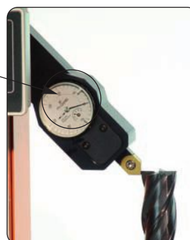
Misurazione del raggio How to measure tool radius
