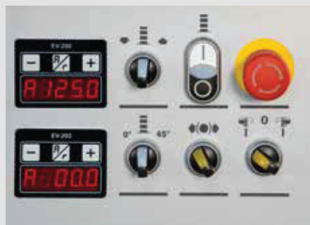
Motorische Verstellung der Arbeitsaggregate mit Digitalanzeige Für größere Präzision und bequemere Anwendung.
